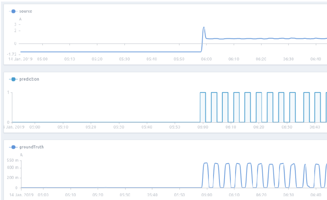
Abbildung 1: Das oberste Diagramm zeigt den Verlauf des gesamten Stromverbrauchs, das mittlere Diagramm das Ergebnis der Analyse für eine Komponente (0 bedeutet inaktiv, 1 bedeutet aktiv). Ganz unten ist zur Kontrolle die Aufzeichnung des Stromsensors dieser Komponente dargestellt. Der Verbrauch dieser Komponente macht bei Aktivität ungefähr 5 Prozent am gesamten Verbrauch aus (Achsenskalierung beachten!).
